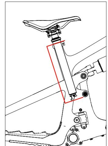
\*Ziehe bei kabelgebundenen Vario-Sattelstützen 34 mm ab, um den Biegeradius der Zughülle zu berücksichtigen.
