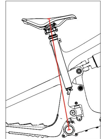
\*Diese Maße gelten nur für kabelgebundene Vario-Sattelstützen. Bitte stelle sicher, dass es bei einer kabellosen Sattelstütze nicht zum Kontakt zwischen Reifen und Akku kommt, wenn die Stütze vollständig abgesenkt und die Federung voll eingefedert ist.
